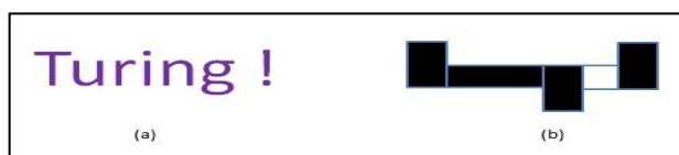
Figure 2. Modélisation d'une chaîne de caractères par des formes rectangulaires. (a) La requête (b) La suite de rectangles modélisant la requête.
