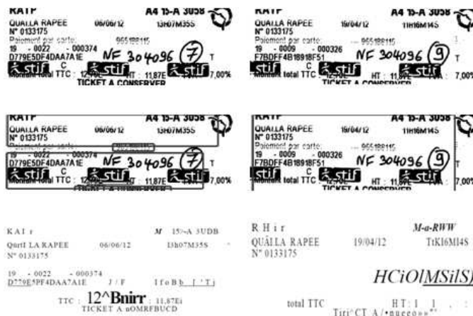
Figure 2. Complexité de l'extraction du texte et de la mise en page : deux images originales de la classe "RATP" (ligne 1), les structures extraites (ligne 2) et les résultats de l'OCR (ligne 3). La mise en page et l'OCR sont effectuées par FineReader 10. Pour ces deux documents très similaires, la mise en page et le texte extraits sont très différents.
